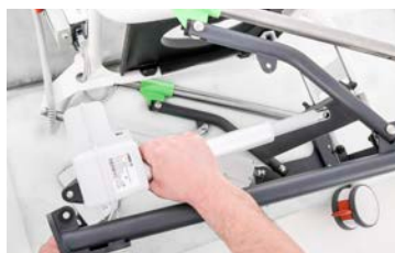
Gehele aandrijvingscilinder losgekoppeld
