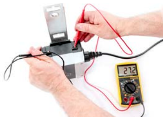
Überprüfung der Spannung des Ladegerätes
