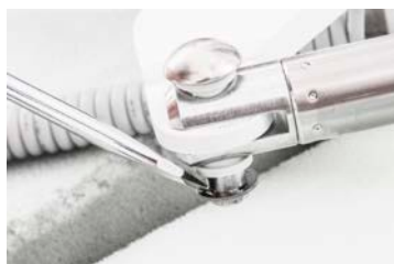
Entfernen des Sicherungsrings 1
