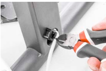
Schneiden des Kabelbinders
