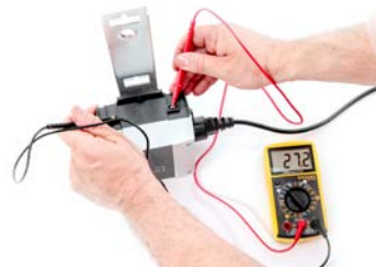
Spanning op de lader controleren
