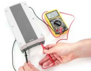
Spanning op de batterij controleren
