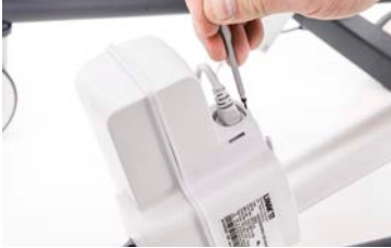
Entfernen der Sicherheitsverriegelung
